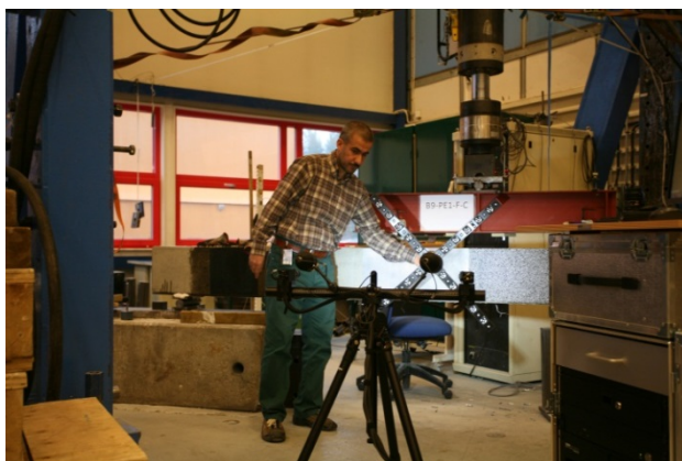
Figur 8 Kalibrering av ARAMIS
